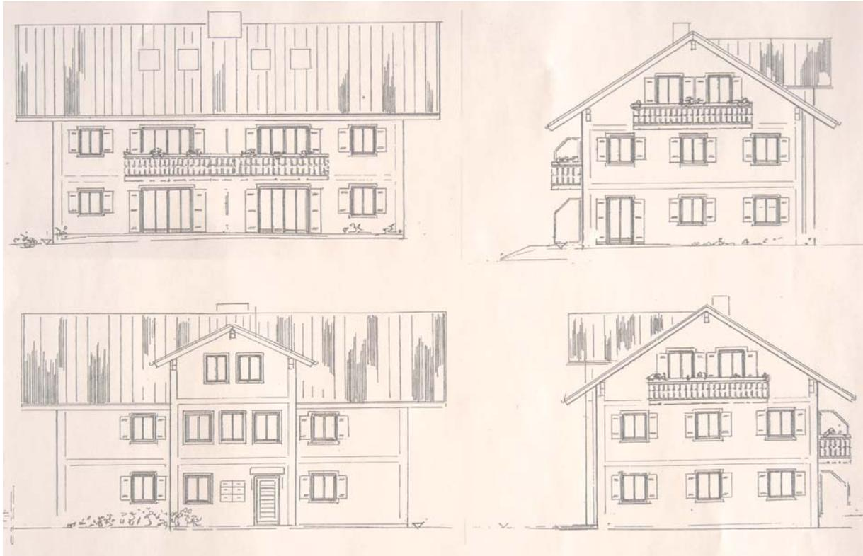
Während auf der Südseite in Richtung Dorfbach die Terrassen und Balkone zur Ausführung kommen, wird auf der Nordseite (zur Schule) im Querbau das Treppenhaus sowie ein Aufzug bis in das Dachgeschoss untergebracht. Sämtliche Wohnungen sind barrierefrei.
