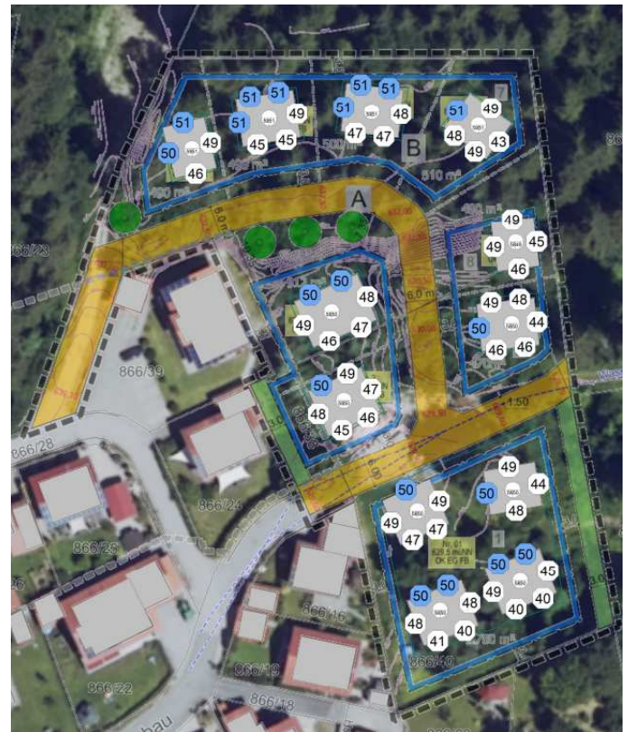
Abb. 15 Erforderliche Schallschutzmaßnahmen gegen Verkehrsgeräusche (> 49 dB(A)) (IB Greiner)
