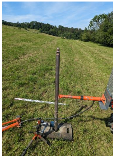
Foto 2: Durchführung des Schrägzugversuchs: Durch den Kolbenhub des orangen Hydraulikzylinders wird eine Belastung unter Windsog in dem entsprechenden Kraftansatzwinkel simuliert. Der Hydraulikzylinder steht dabei auf einer Platte mit rauer Oberfläche und großer Auflagefläche, welche sowohl das Wegrutschen als auch die Setzung des Zylinders verhindern soll. Die Verschiebung des Pfahlkopfes wird mit einem elektrischen Wegaufnehmer (1/100 mm Messgenauigkeit) gemessen, welcher an einem unabhängigen Referenzsystem befestigt ist.
