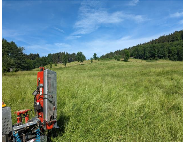
Foto 1: Blick auf das Baufeld: Die Erkundungsarbeiten wurden mit einer Sondierraupe vom Typ PR 530S der Firma "Geodunkel" durchgeführt.
